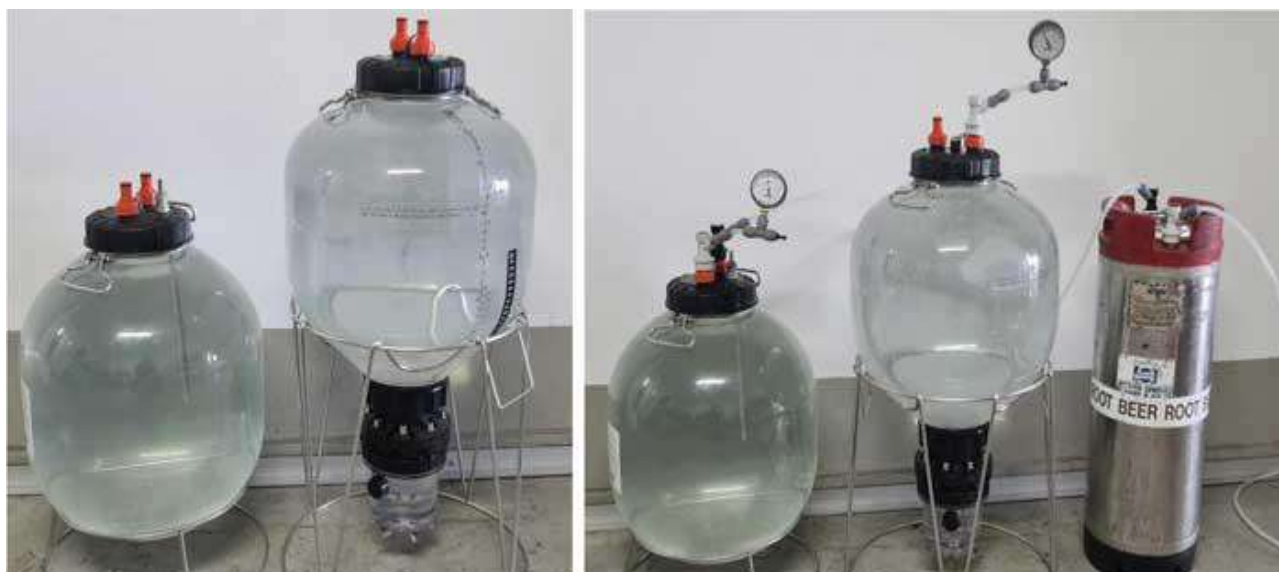
В ферментерах All Rounder 30 л и ЦКТ/Unitank 27 л повышенное давление – 4,5 атм. Во время гидротестирования
