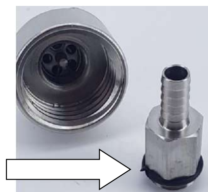
Повреждённое уплотнительное кольцо
