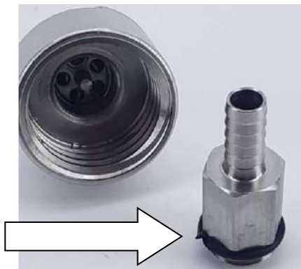
Повреждённое уплотнительное кольцо
